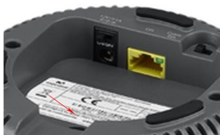
Figura 17 - Localização da senha de acesso ao repetidor
